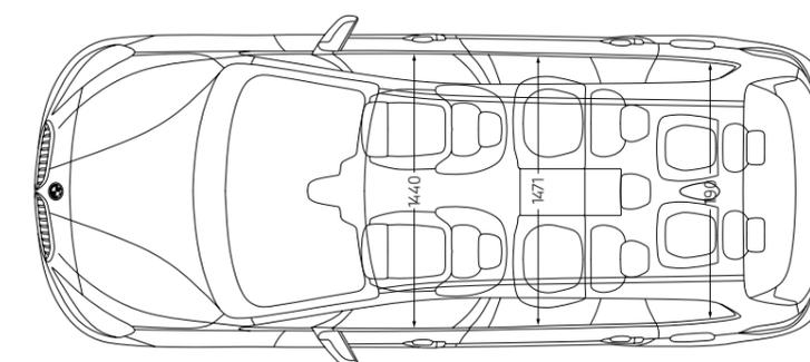
Alle Maßangaben der technischen Zeichnung in Millimeter. Werte in [ ] gelten für Fahrzeuge mit Steptronic Getriebe.
