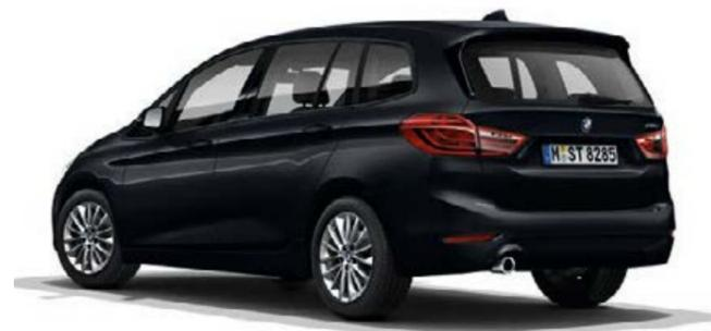
BMW 216d, Auspuffendrohr sichtbar, einfach, rund, mit Chromblende
